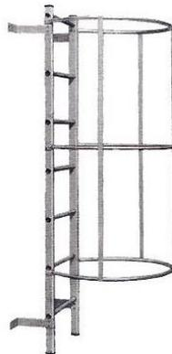
O Guarda-corpo para a escada marinheiro será em ferro, com espessura de 2,00mm (chapa 14). Com peças em seções retangulares com dimensões de acordo com o indicado no projeto. Todas as peças deverão possuir proteção à corrosão. As peças serão montadas e soldadas, posteriormente serão parafusadas umas nas outras, no local e momento de montagem.
